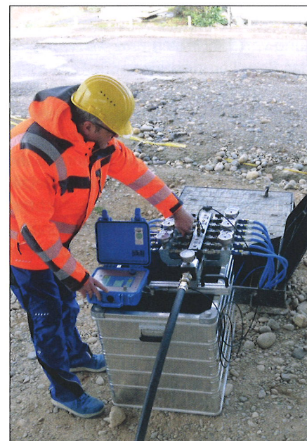
Bild 1: Elektronisches Druckprüfgerät DPG 17U mit Zwölfach-Verteilereinheit für Subducts
