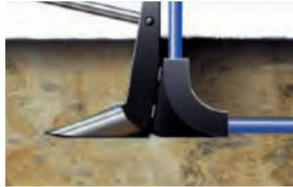
Das Rohrsystem kann bei diesem Verfahren je nach Bodenklasse oberflächlich verkratzt werden. Zusätzlich können Steine über einen längeren Zeitraum die Außenwand des Rohres Punkt- oder Linienförmig belasten.
