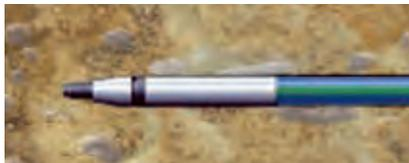
Das anstehende Erdreich kann das Rohr zerkratzen. Zudem können umliegende Steine zu Punktlasten auf dem Rohr führen.
