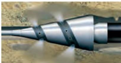
Dieses Verfahren ist besonders geeignet für eine Rohrverlegung in Innenstädten bei denen kein Abzweig notwendig ist oder für Unterquerungen von Gewässern, Straßen etc.
