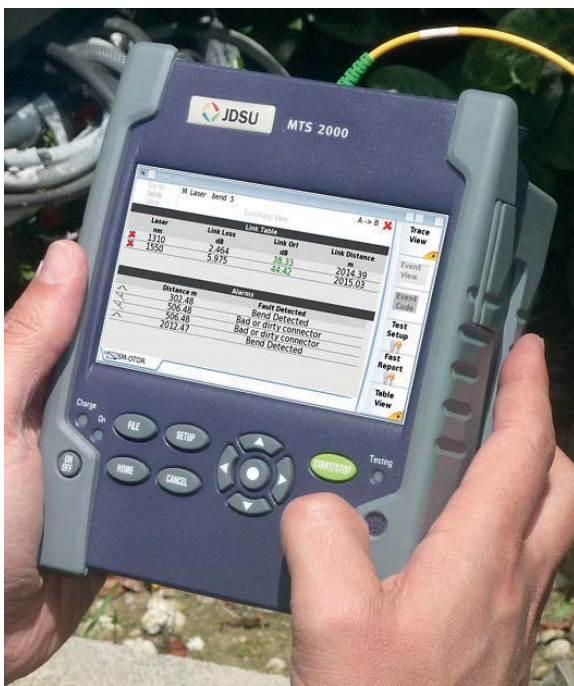
Abb. 1: Das OTDR MTS-2000 von JDSU mit Software SmartLinkMapper
