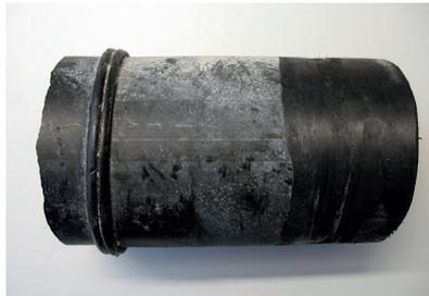
**Bild 1:** Rohrstück mit Spiegelschweißung
